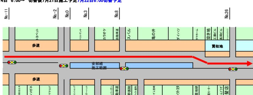
7月22日 路面切替・中間層・仮区画線→切替(上り線) 上り線1車線規制(21:00~6:00)8月3日施工予定
